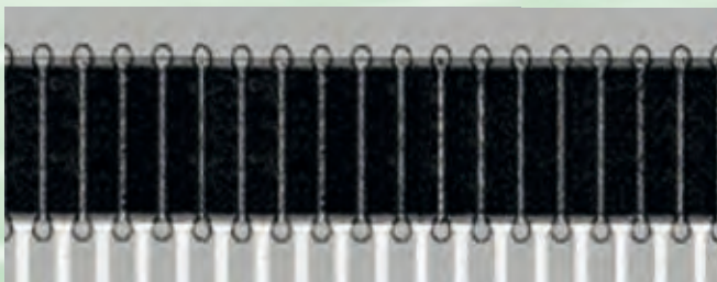
热释电钽酸锂芯片的详细视图, 带有额外的金属黑色涂层和离子束蚀刻隔离槽。
